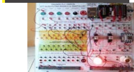
Panel Kit PLC dengan HMI karya mahasiswa Universitas Nusa Putra, Radete, Anton, dan Latief (atas). Panel PLC karya Irwan dan Ismet dilengkapi input dan output yang sering dipergunakan untuk kegiatan praktek (bawah).
